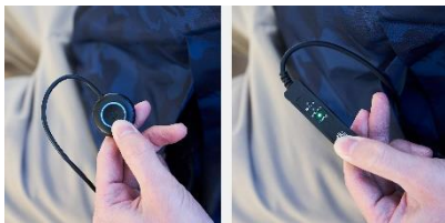
(画像左) ペルチェプレート電源 (画像右) ファン電源
